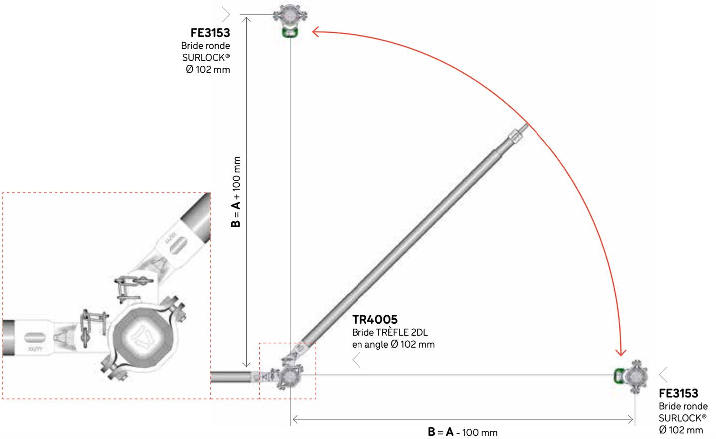
Montage sur poteaux diamètre 102 mm avec brides 2D réf. TR4002, SURLOCK® réf. FE3153 et double SURLOCK® réf. FE3156.
