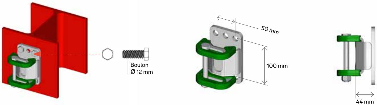
La ferrure double SURLOCK® réf. **FE3014** se fixe sur les semelles de poteau de charpente.
