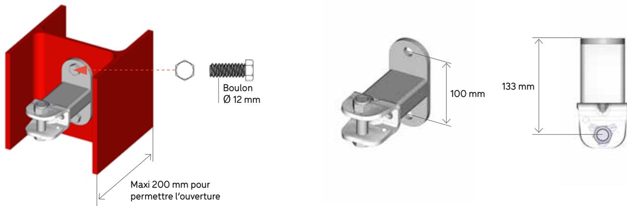
La multifix renforcée réf. **FE2015** se fixe sur un petit poteau de charpente en I en perçant les semelles.
