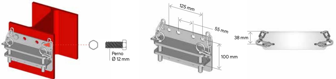
El multifix **ref. FE2017** se fija en un poste pequeño estructural en I perforando los patines.
