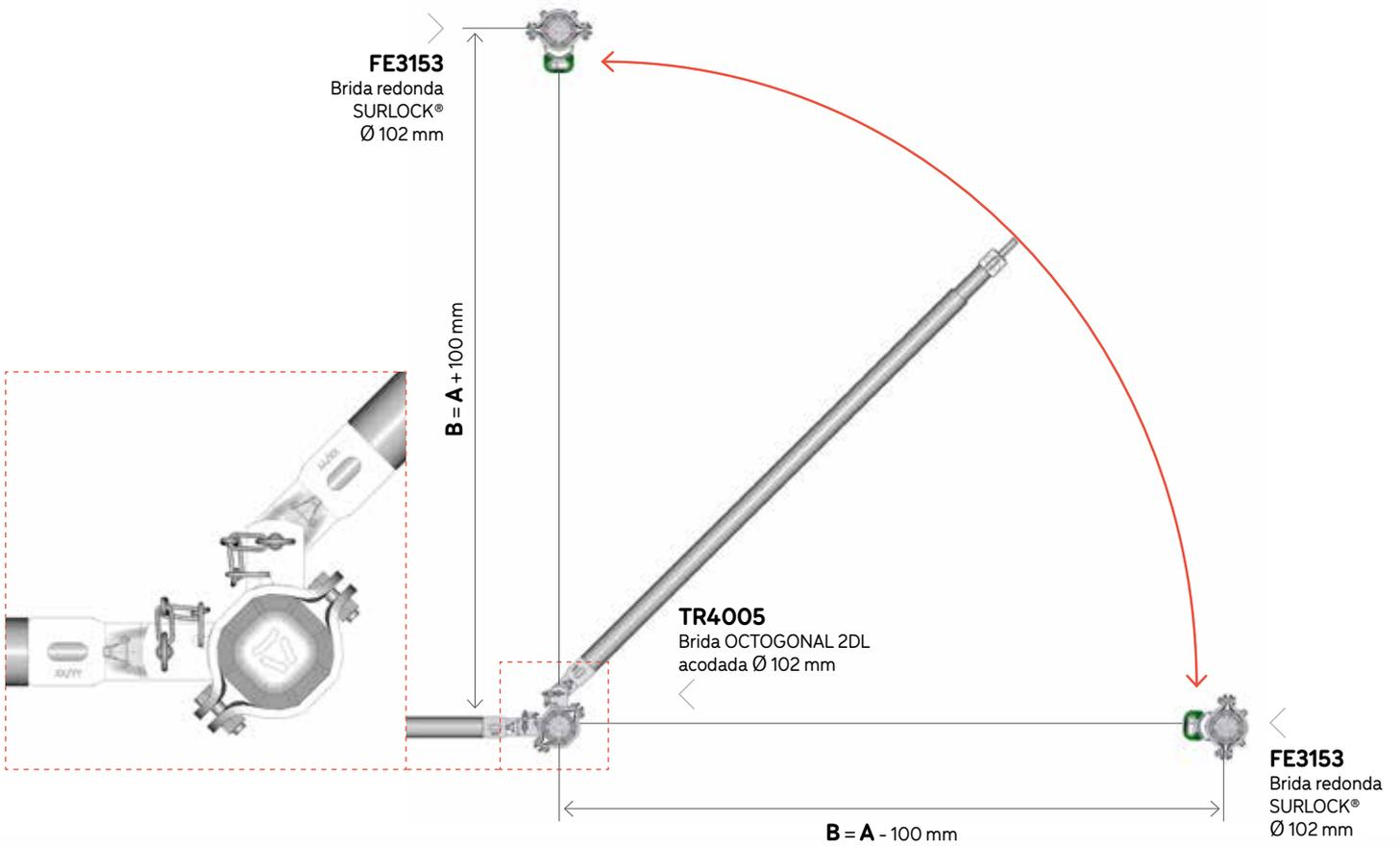
Montaje en postes de 102 mm de diámetro con bridas 2D **ref. TR4002**,
