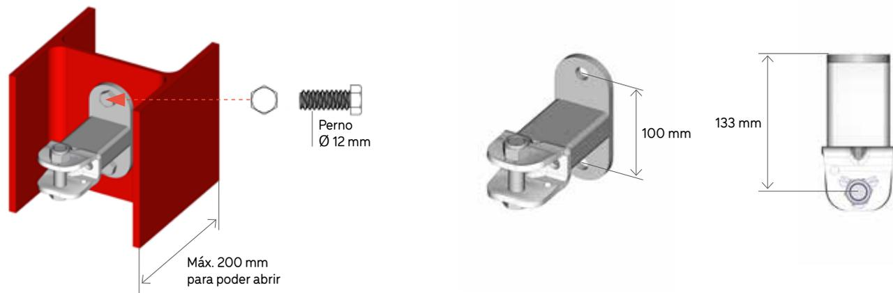
El multifix reforzado **ref. FE2015** se fija en un poste pequeño estructural en I perforando los patines.
