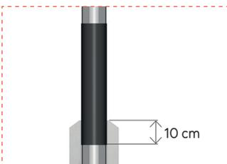
Passen Sie die Höhe der Schutzummantelung an die Auflagefläche an – 10 cm unter dem Beton – und lassen Sie den einbetonierten Metallpfosten in direktem Kontakt mit dem Beton.
